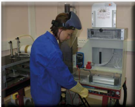
Diagnostic sur un système automatisé de production à l'aide d'un multimètre
